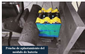
Prueba de aplastamiento del módulo de batería
