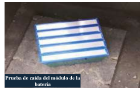
Prueba de caída del módulo de la batería
