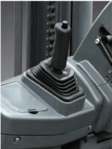
Nuevo tipo de palanca de freno de mano que reduce un 17% la fuerza necesaria para accionarlo..
